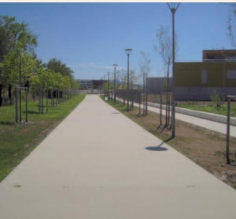
Les voies piétonnes et cyclables ont été réalisées en béton sablé (granulat Roussas coloré jaune, 4/6).
