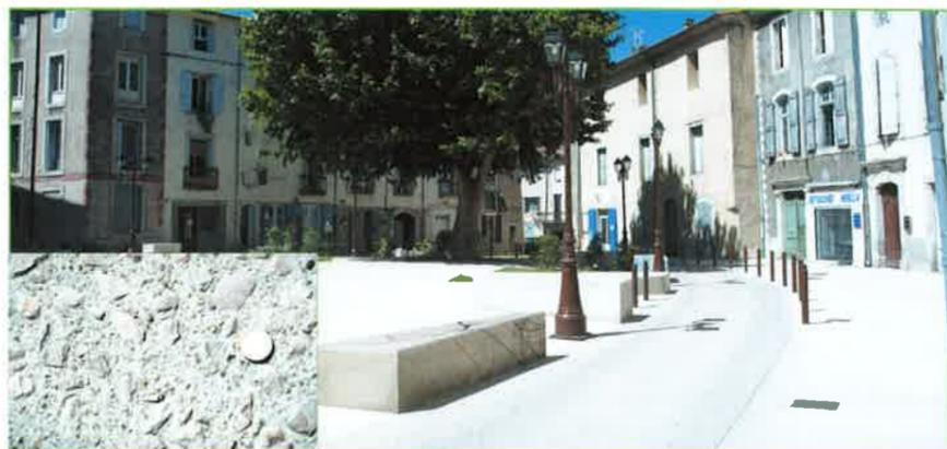
Ganges : le béton désactivé sablé clair a été choisi afin de redonner luminosité et cachet aux façades de la place principale. Le sablage du béton désactivé a aussi permis d'adoucir les angles des granulats concassés.
